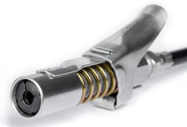
Le système est livré avec un flexible de 2m (pression d'éclatement de 1.600 bar) équipé d'une agrafe spéciale. Cette agrafe spéciale se fixe au graisseur à l'aide d'un embout à piston et levier.
